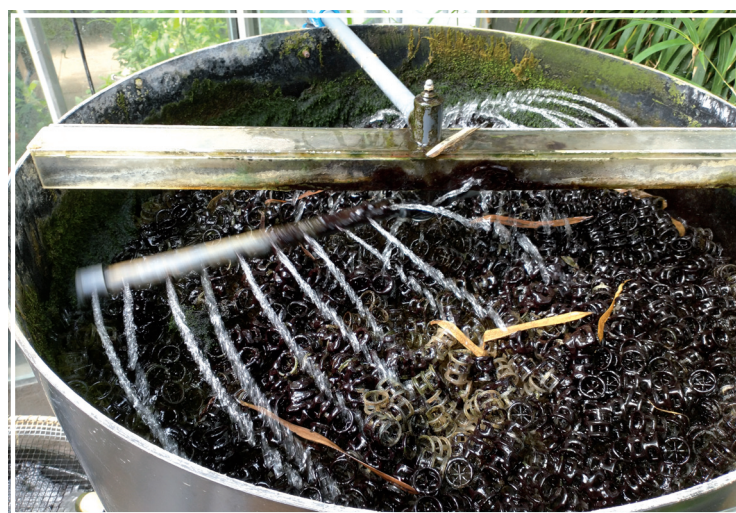
Obr. 2 – Biofiltr je díky nitrifikačním bakteriím jádrem akvaponického systému. Z vody odstraňuje toxický amoniak, a vytváří živiny pro rostliny. Nárůst řas v biofiltru je podhoubím pro další infekce a choroby
