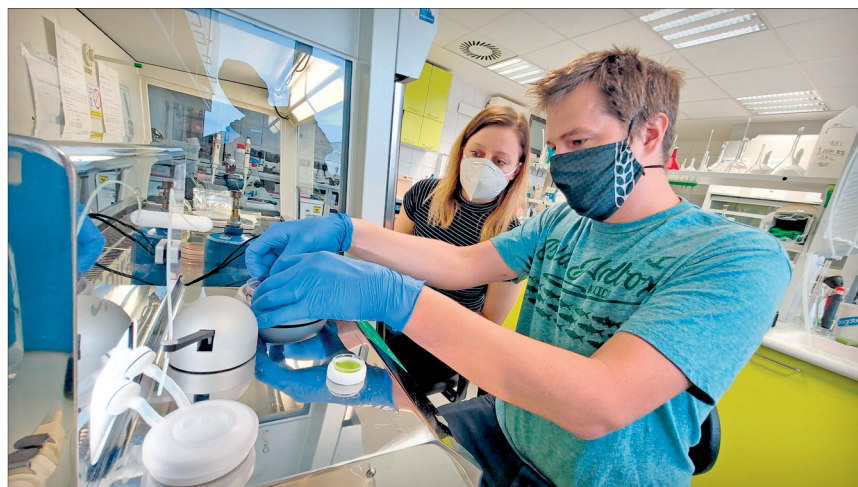
Práce v laboratoři, mikrobiologická analýza rostlinných vzorků na přístroji Spiral Plater
